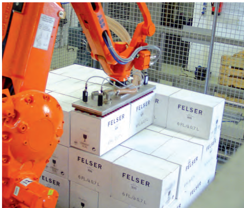
Palettierroboter mit Vakuum-Sauggreifern
