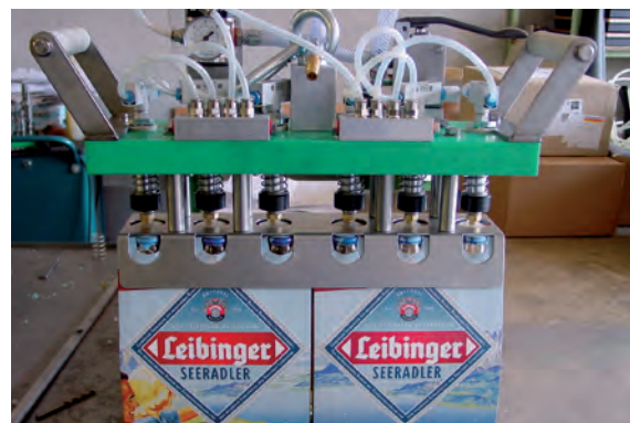
Spezial-Handpackkopf zum Umpacken von 2 Sixpack-Verpackungen in Pinolenkasten
